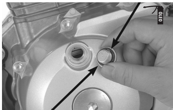
TAMPA DO ORIFÍCIO DE SINCRONIZAÇÃO BOBINA DE IGNIÇÃO CONECTORES DA FIAÇÃO
