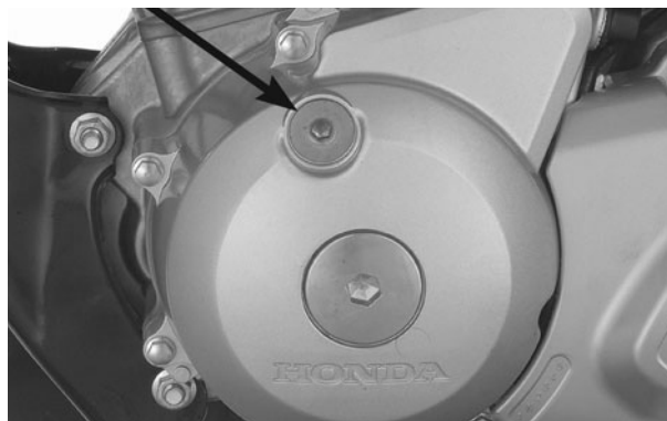
TAMPA DO ORIFÍCIO DE SINCRONIZAÇÃO
